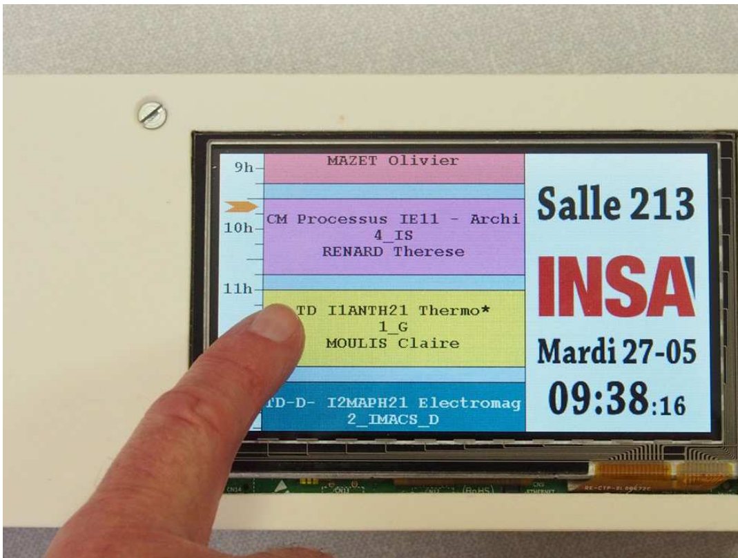
Photo 1: L'agenda électronique des salles sur une carte Discovery-F7
